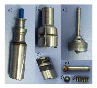
Figure 7 Dismantled GDI injector a) core body 1,b) core body 2,c) injector nozzle, d) injector needle, e) pin, F) washer and g) spring.
